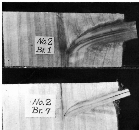
第 2 図 年輪完備枝と年輪欠如枝の縦断面写真。上は年輪完備枝、下は 2 年輪欠如のもの。
